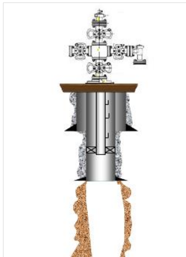
Figura 2-77 Esquema tipo de completamiento en hueco desnudo
